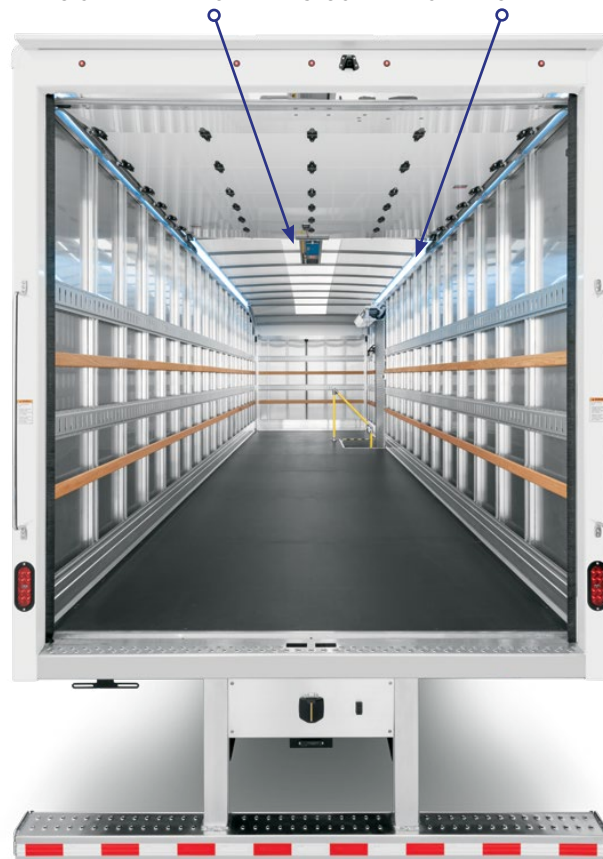
PANNEAU CENTRAL DE TOIT TRANSLUCIDE ÉCLAIRAGE À BANDE LED
